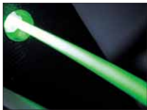
Die Quarzglas-Nadel eines Schwammes wird in einem Labor mit einem grünem Laser ausgeleuchtet.
